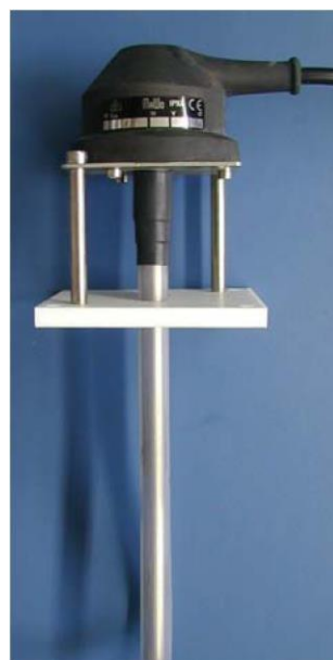
PTFE пластина с конструкцией для уплотнения закрытого резервуара
